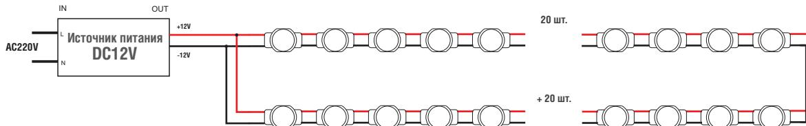
**ПРИМЕЧАНИЕ:** Обратитесь к схеме подключения для установки. Неправильное подключение может привести к короткому замыканию!
